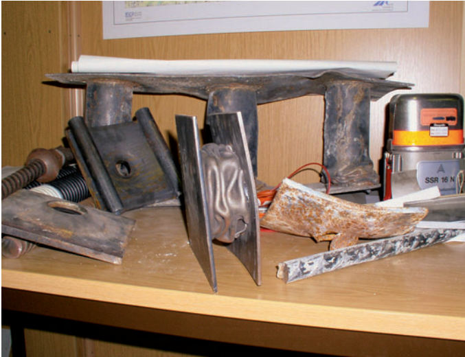
Obr. 5 Deformační prvky vkládané do primárního ostění a na desky kotvěv Fig. 5 Deformation elements inserted into the primary lining and fixed to the anchor face plates
