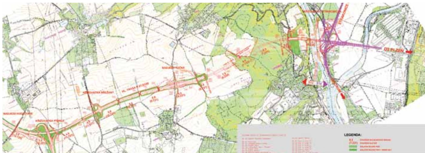
Obr. 1: Situace: Stavba 513 s napojením na stavbu 514. Zvláště vyznačeny jsou tunely a hloubené portálové úseky.
